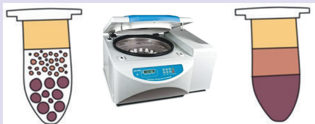
Figura 6. Centrifugarea în cazul amestecului solid-lichid și lichid-lichid
